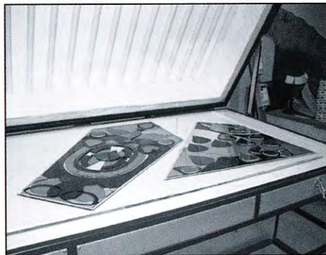
Zu brennende Fenster für die Einsegnungshalle des neuen Friedhofs in Lieser
